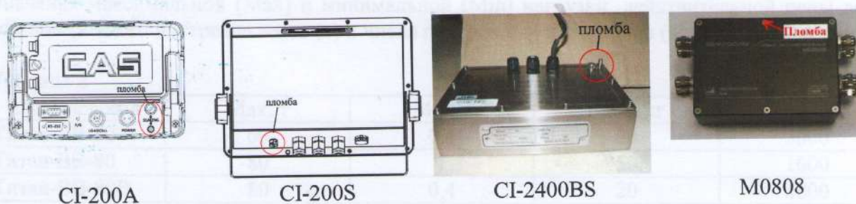
Рисунок 4 - Схема пломбировки приборов весоизмерительных
